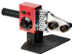
16. Сварочный аппарат для полипропилена (диаметр насадок 20–63 мм)
